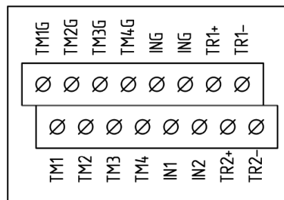
Рисунок 9.1 – Схема подключения счетчиков РиМ 489.08-К
